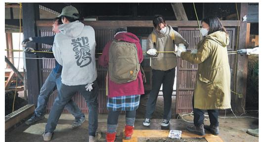
巨大吹子 | 古民家内廊下部分を用いて、窯に熱を送るために制作された巨大吹子。人力にて稼働する。
