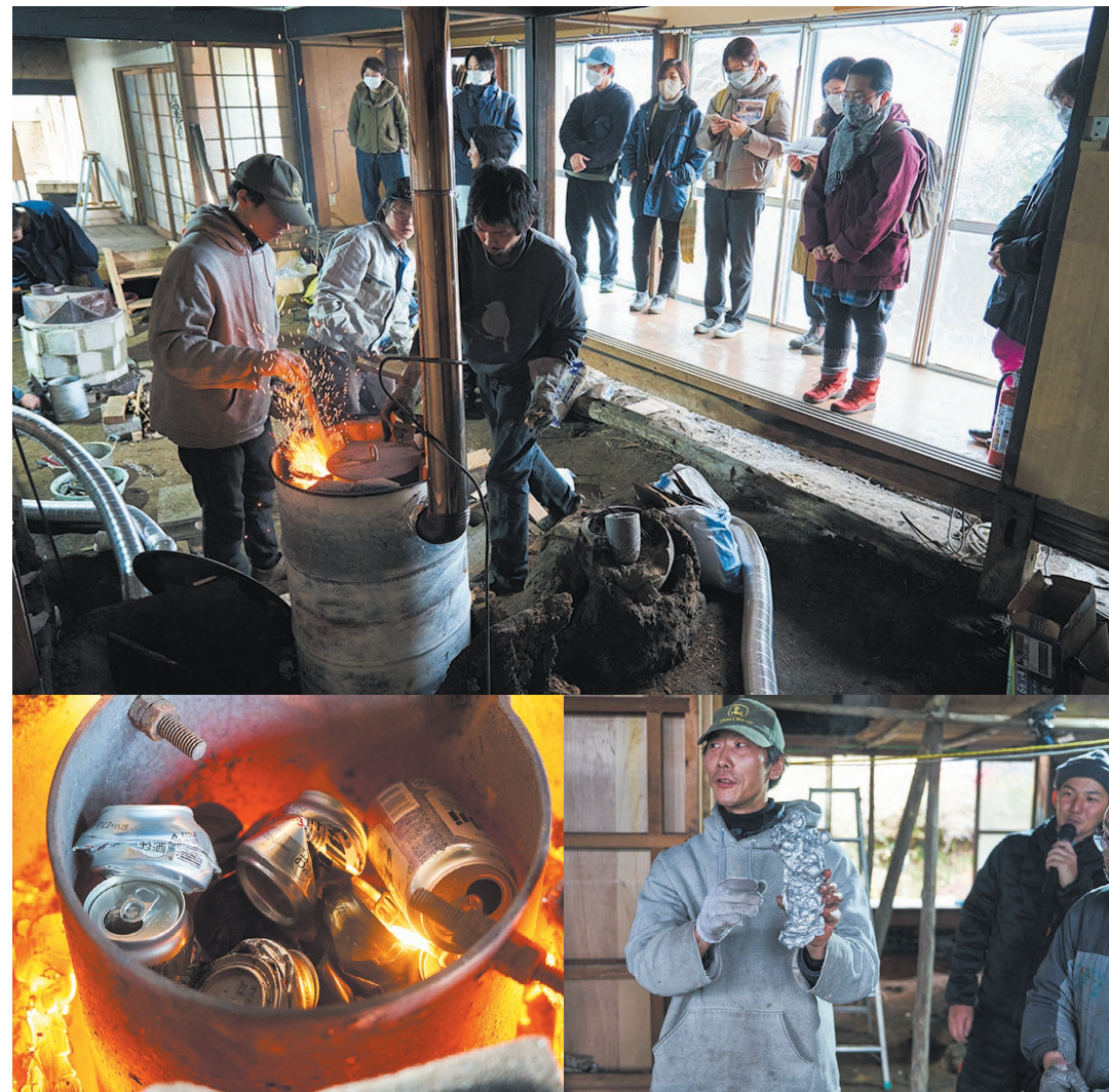
アルミ窯 | アルミ鋳物作品を製造する、アルミを溶かす窯。
