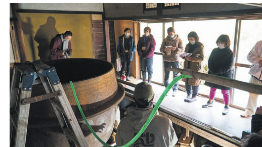
寒天窯 | もとは寒天を茹でるために使われた巨大な釜でお湯を沸かすため、火入れ用の窯が下部に作られた。
