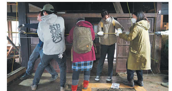
巨大吹子 | 古民家内廊下部分を用いて、窯に熱を送るために制作された巨大吹子。人力にて稼働する。
